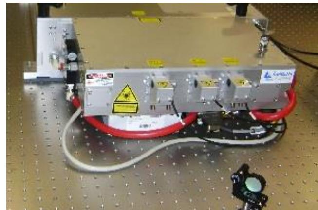
Fabricare prin ablatie laser de structuri cu rezolutie submicrometrica: circuite si dipozitive micro-electronice, senzori.
